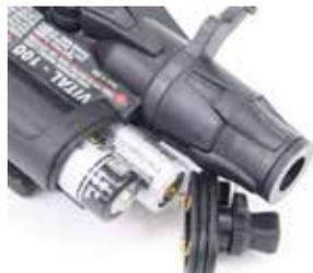
**Operación con pilas** El VITAL opera con 2 pilas de litio AA (incluidas).
