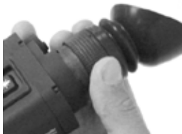
Figura 3-7. Ajuste de la Dioptría.
